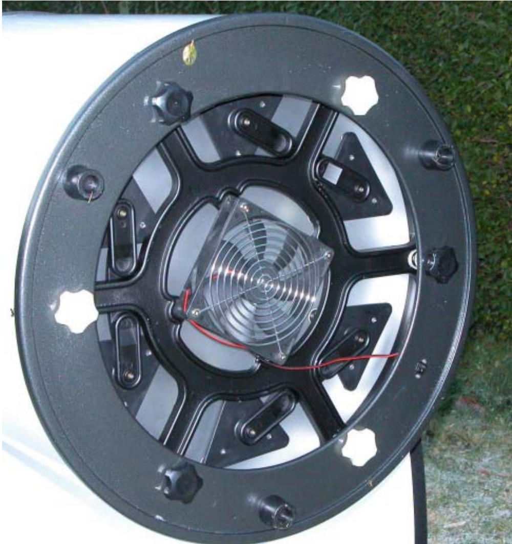
Foto 5: Collimatiebouten van de hoofdspiegel
