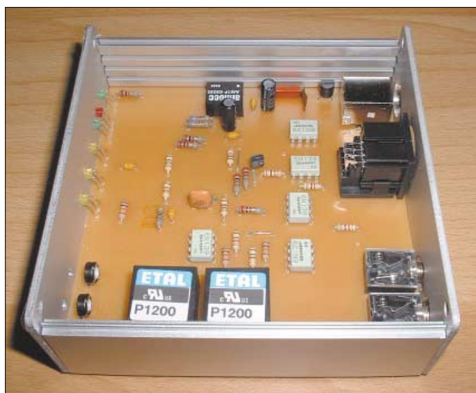
Bild 1: Fertige Baugruppe im geöffneten Gehäuse, hier noch mit anderen Transformatoren als den empfohlenen
